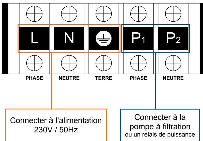
**Étape 3 :** Raccordez le câble d'alimentation au bornier selon le schéma ci-dessous.
